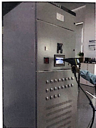
静电放电试验布置图
